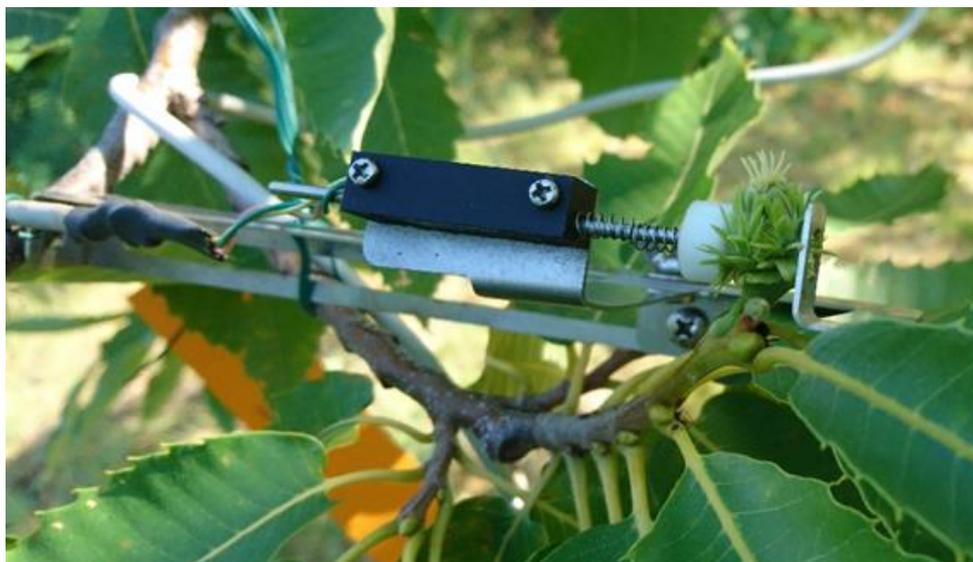
Figura 5 - Fruttometro per il monitoraggio, in automatico, della crescita del riccio
