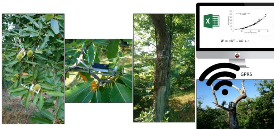
Figura 6 - Set-up della sperimentazione: sensori base pianta, stazione meteorologica e centraline con relativi nodi per l'acquisizione ed invio del dato, in tempo reale, su piattaforma online.
