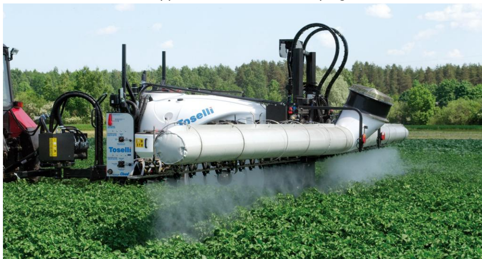
Barra irroratrice con manica d'aria in funzione
