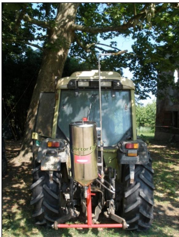
**Fig. 5:** la distribuzione di spintor-fly può essere realizzata con specifico atomizzatore da applicare al trattore (28 litri) o, in alternativa, manualmente con spruzzetta/pompa a spalla (2-5 litri di portata)
