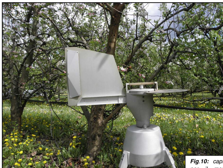
**Fig.10:** captaspore volumetrico utilizzato per il monitoraggio di ascospore di ticchiolatura del melo e del pero
